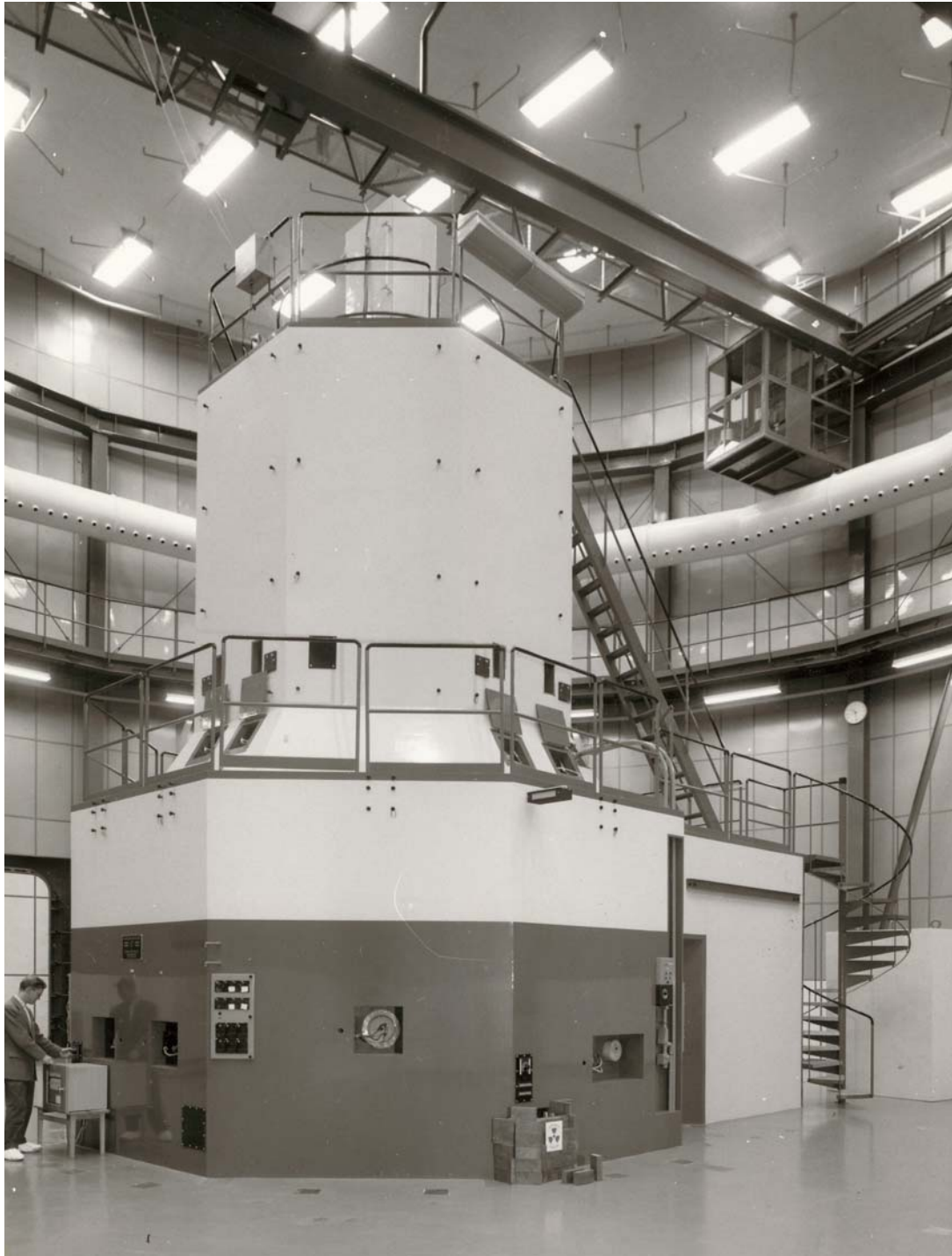
Figur 5. Risøs amerikanskproducerede DR2-reaktor var, fra 1959 til den i 1975 blev lukket, Isotoplaboratoriets vigtigste bestrålingsfacilitet. Selvom DR2 ikke var ideel til isotopproduktion, bød reaktoren på en række forskellige bestrålingsmuligheder. Prøverne blev placeret i små aluminiumsdåser og derefter med håndkraft indført i reaktoren gennem et af reaktorens mange forsøgsrør. Fra toppen af tanken var der adgang til en bestrålingsfacilitet i selve reaktorkernen og fra hullerne på balkonen var der adgang til forsøgsrør i reaktortanken. Isotopproduktion kræver ofte korte og meget præcise bestrålingstider. Isotoplaboratoriets vigtigste opgave inden opstarten var at få fremstillet særligt udstyr, der tillod udtagning af bestrålinger under drift, hvilket lykkedes for alle de nævnte faciliteter undtagen for den termiske kolonne. Den termiske kolonne var en grafitkolonne, som var beregnet til at producere et neutronbeam med lav energi (dvs. termiske neutroner). På billedet ses den mellem vindeltrappen og selve reaktortanken. Fra Isotoplaboratoriet var der desuden via rørpost direkte adgang til en bestrålingsposition, hvortil prøverne blev sendt i små beholdere kaldet "kaniner". Kilde: Risøs Billedarkiv.
