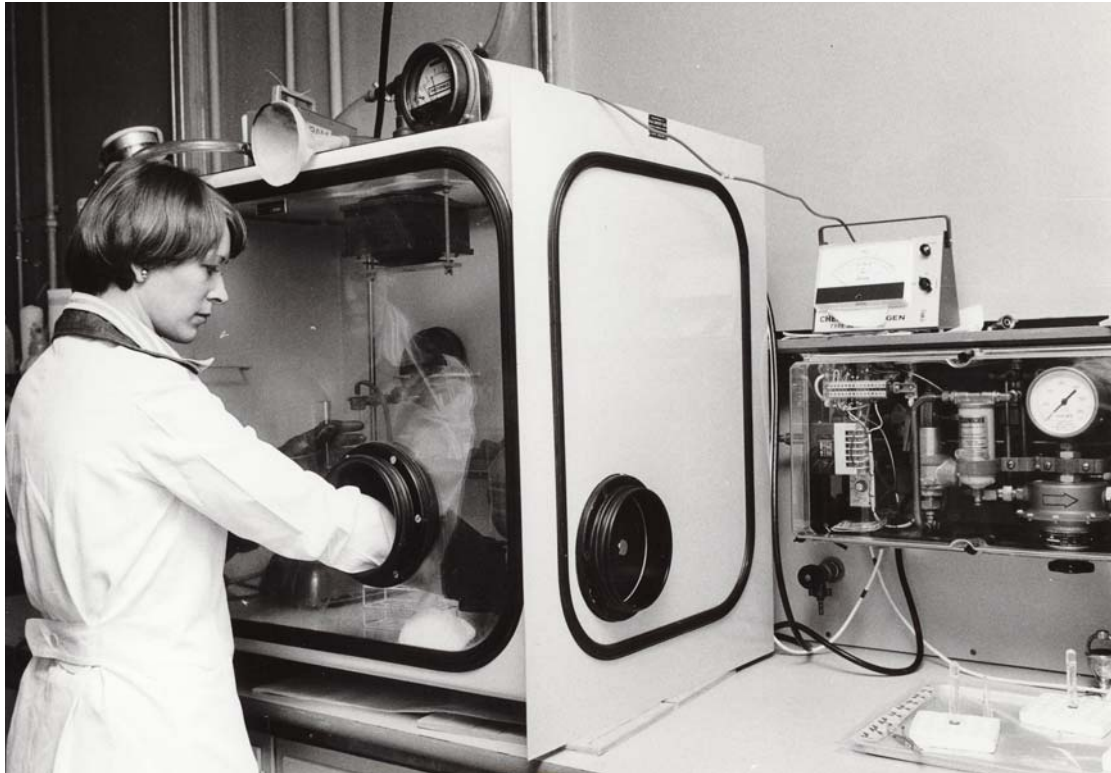
Figur 12. Laboratorieassistent Anni Schultz Rasmussen håndterer radioaktivt mærkede forbindelser i handskekasse. Laboranterne på Isotoplaboratoriet var vanen tro udelukkende kvinder. Laboranter og teknikere var typisk dem, der modtog de største strålingsdoser. For gravide kvinder indebar dette et specielt problem, idet fostret er mest følsomt over for stråling i perioden inden graviditeten normalt kan konstateres. Foto fra 1970'erne. Risøs Billedarkiv.
